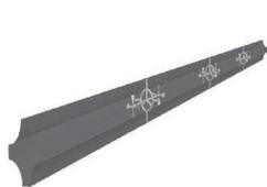
图 1 扰流叶片换热器的计算单元
